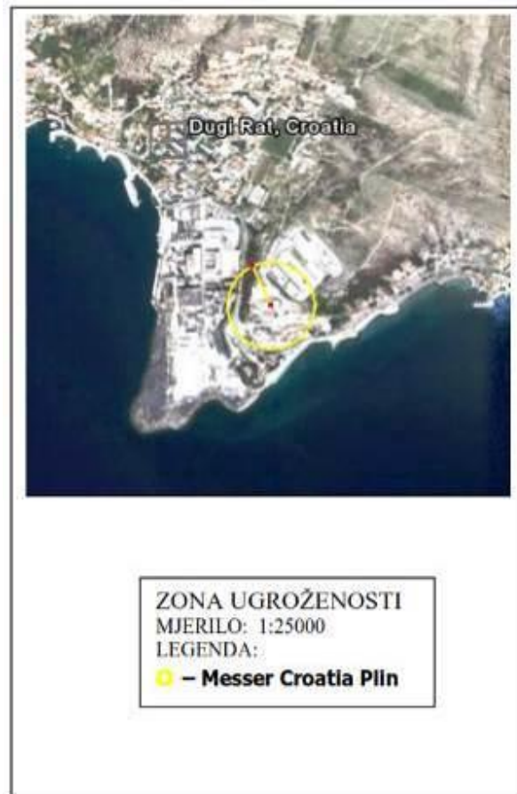
Grafički prikaz 4. Zona ugroženosti za najnepovoljniji slučaj («Worst - case») istjecanja kisika i acetilena iz pogona Messer Croatia plina d.o.o. Dugi Rat
