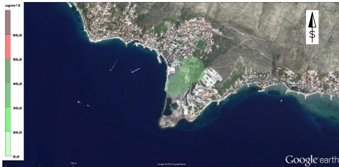
Grafički prikaz 7. Model disperzija praškastih tvari u zrak pri radu drobiličnog postrojenja uz otprašivanje (M 1:25.000)
